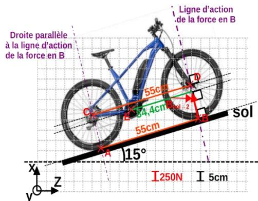
On se rend alors compte que le point D se trouve sur cette ligne d'action : cela implique que la distance entre le point D et la ligne d'action est nulle. Par conséquent :
