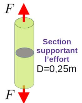
3.  $\sigma = \frac{F}{S} \iff S = \frac{F}{\sigma}$ , si on prend le cas extrême, avec un diamètre minimal du câble résistant à la charge,
