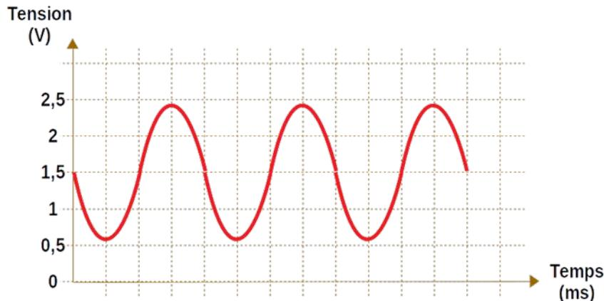
5. Toute fréquence comprise entre la fréquence du signal à conserver (2,5 Hz) et la fréquence du signal parasite (45 Hz) peut théoriquement convenir. En pratique, on prendra de préférence une fréquence de coupure ni trop proche du signal parasite (pour être sûr de bien l'éliminer), ni trop proche du signal à conserver (pour être sûr de ne pas l'affaiblir). Par exemple, 15 Hz, 20 Hz ou 30 Hz sont de bonnes fréquences de coupure.
