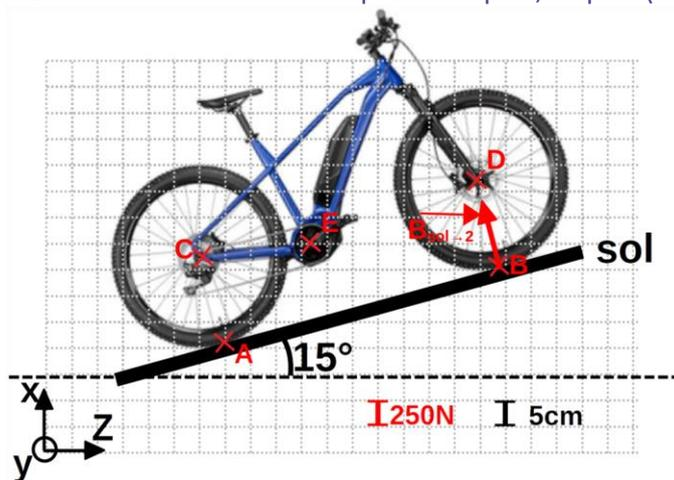
1. À l'aide de l'échelle, déterminez la norme de la force  $\overrightarrow{B_{sol \rightarrow roue}}$ .
