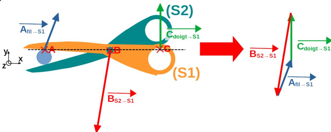
Ce principe graphique, qu'on appelle le **triangle des forces**, peut être utilisé pour rapidement estimer les directions, sens et norme des vecteurs forces pour lesquelles on manque d'information. Il permet aussi de contrôler les résultats trouvés en fin d'étude.
