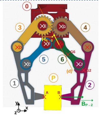
2. La pièce 2 possède une masse de 270g, et son centre de gravité sera le point G2. La résistance à la pression, exercée par la pièce en B (représentée sur l'image ci-contre), donnera une force de 19 N. Effectuez le bilan des forces de cette pièce, et présentez-le sous forme de tableau.
