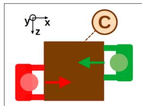
6. La caisse ne peut pas rester immobile, car les deux forces ne sont pas sur le même axe (bien qu'elles soient parallèles). Dans ce cas, la caisse va tourner.
