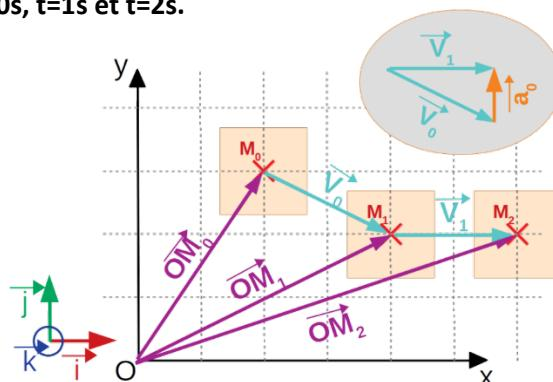
Dans le repère  $(O, \vec{i}, \vec{j}, \vec{k})$ , trois positions prises par le point M, appartenant au solide (S), sont représentées aux instants  $t=0s$ ,  $t=1s$  et  $t=2s$ .
