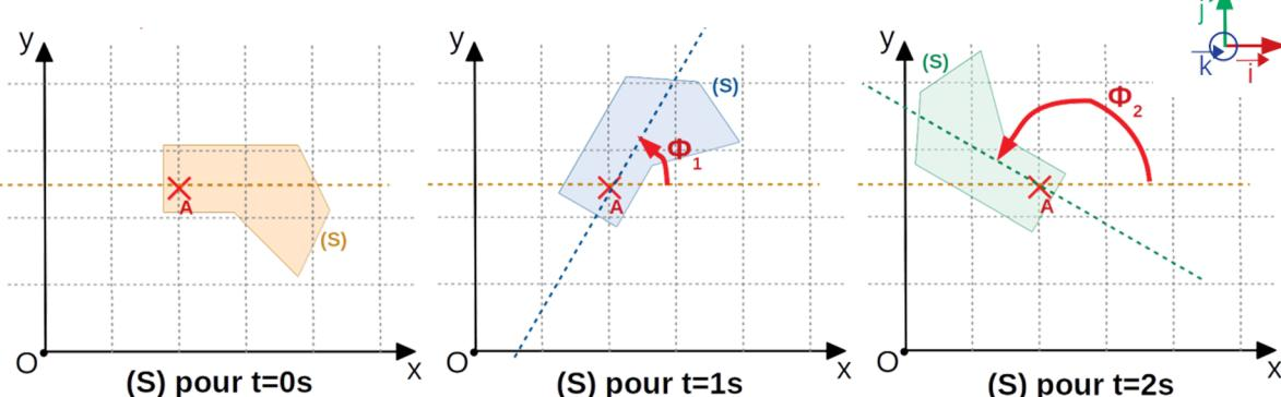
La position angulaire du solide ( $S$ ), à un instant donné, correspond à l'angle entre sa position initiale et sa nouvelle position. Par exemple :
