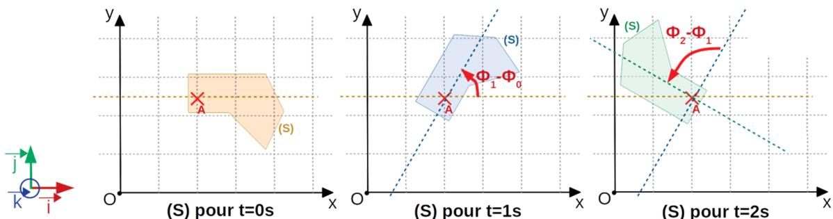
La vitesse angulaire du solide (S), à un instant donné, correspond à la différence de position angulaire entre deux instants, divisée par le temps entre ces deux instants. Par exemple :
